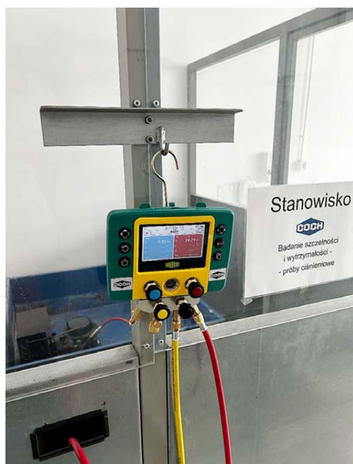
Rys. 10. Przebieg próby wytrzymałości ciśnieniowej (źródło: [10])
