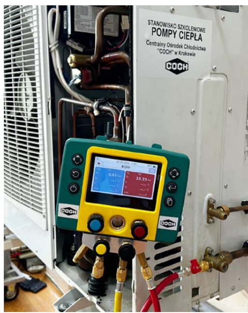
Rys. 1. Próba wytrzymałości ciśnieniowej (źródło: [10])
